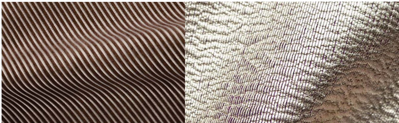
Figura 26 - Couros acabados com recurso a tecnologia laser
