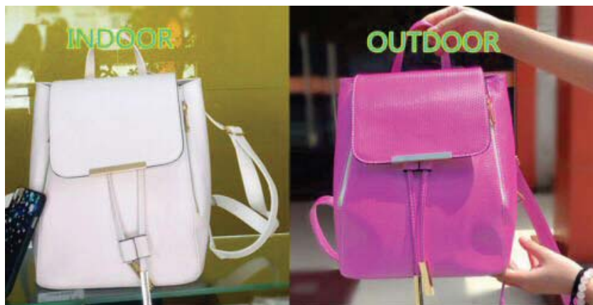
Figura 18 - Comportamento de couro com pigmentos fotocromáticos
